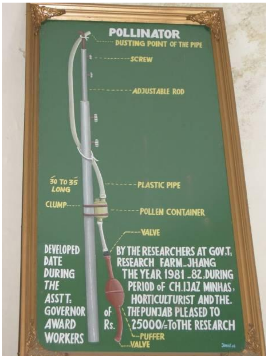
L'appareil à polliniser mis au point à la station de recherche de Jhang.
